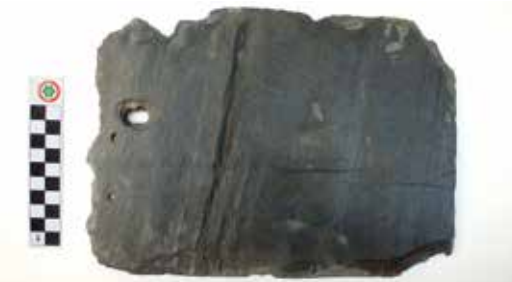
A Lök-völgyi Formáció egyes változatai alkalmasak voltak zsindegy készítésére. A belpátfalvi Apátságot egykor fedő zsindegyalán határozottan látható a kőzet eredeti rétegzettsége és a harántpalásság. (H. S.)
